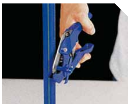
Ucięcie wystającej części kołka
