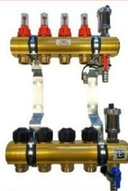
Vissen Auto rozdzielnica z wkładkami termostaticznymi pod siłowniki, rotametrami, zaworami napełniająco-odpowietrzającymi i odpow. automat.
