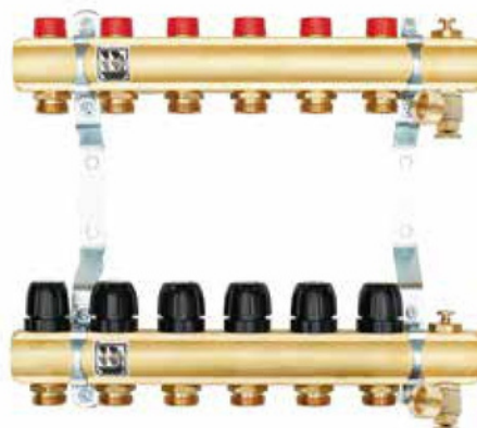
RP rozdzielacz z wkładkami termostatycznymi pod siłowniki, zaworami regulacyjno-odcinającymi, odpowietrznikami i zaworami spustowymi
