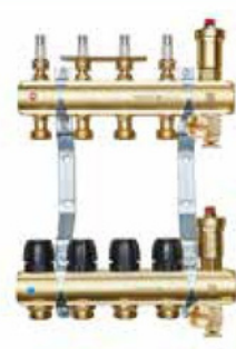
RP-R Magnetic Auto rozdzielacz z wkładkami termostatycznymi pod siłowniki, rotametrami magnetycznymi, zaworami spustowymi i odpowietrznikami automatycznymi *
