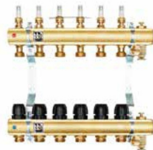
RP-R Magnetic rozdzielacz z wkładkami termostatycznymi pod siłowniki, rotametrami magnetycznymi, zaworami spustowymi i odpowietrznikami ręcznymi
