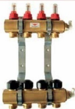
RP-R Basic rozdzielnica z wkładkami termostatycznymi pod siłowniki, rotametrami i zaworami napełniająco-odpowietrzającymi
