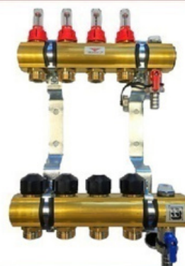
Vissen rozdzielnica z wkładkami termostatycznymi pod siłowniki, rotametrami, zaworami napełniająco-odpowietrzającymi i odpow. ręcznym
