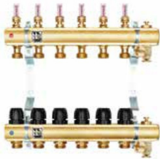
RP-R rozdzielacz z wkładkami termostatycznymi pod siłowniki, rotametrami, zaworami spustowymi i odpowietrznikami ręcznymi
